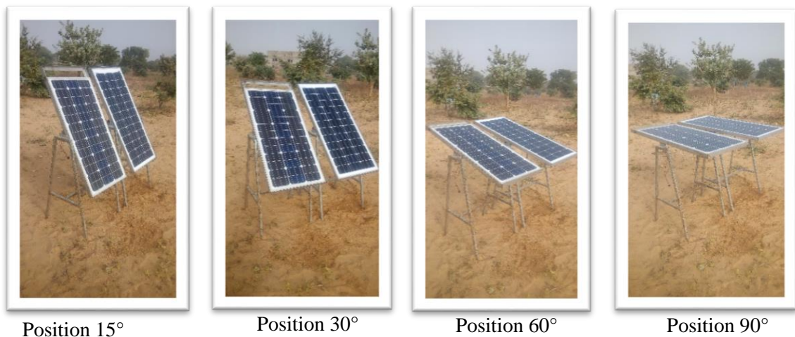
Figure IV. 6 : Les panneaux PV SA-80 et AP-PM 100 sous différentes inclinaisons
